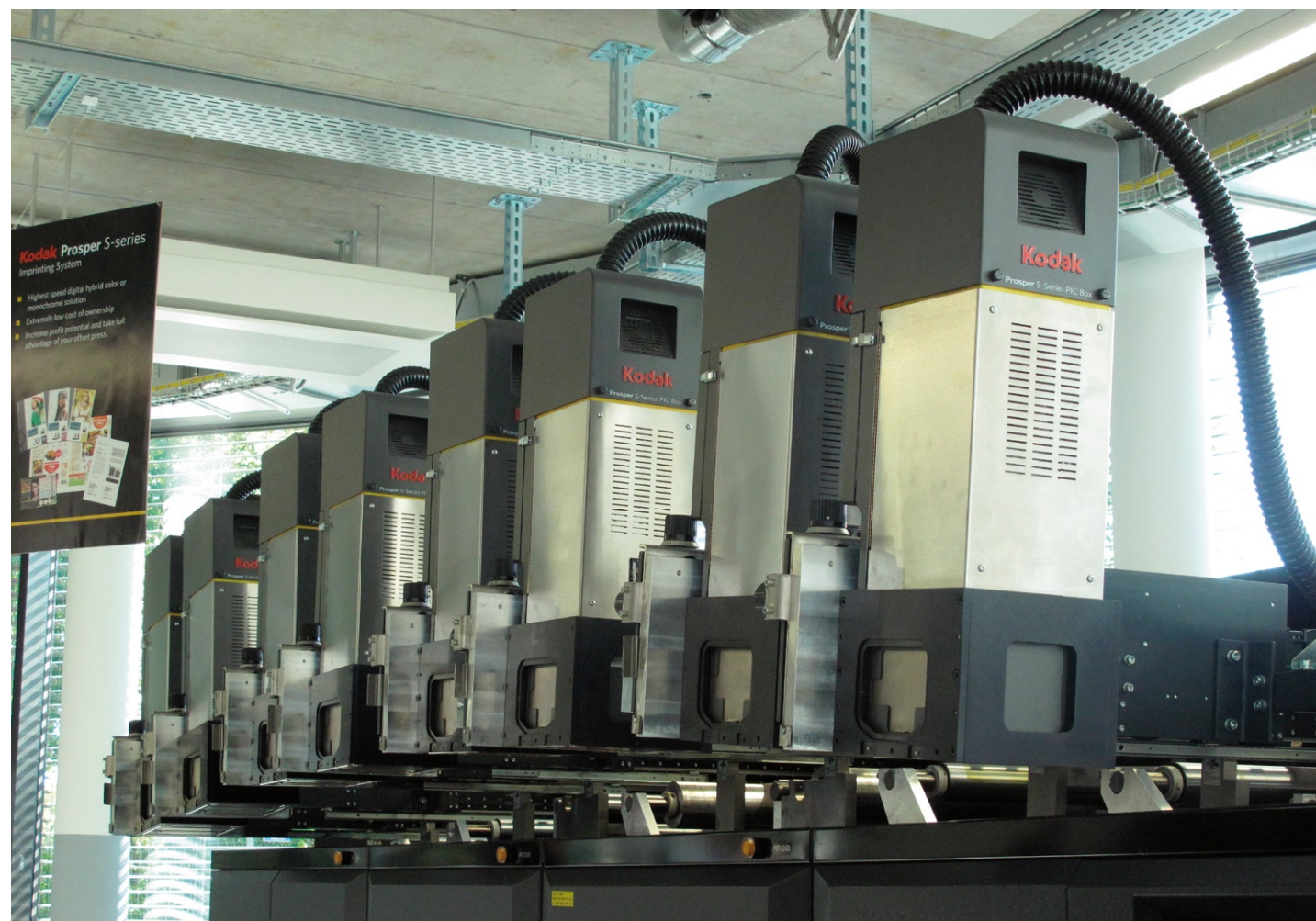
Per i propri sistemi inkjet Kodak Prosper S-Series Imprinting, Kodak produce inchiostri di tipo personalizzato, a base di coloranti, a base di pigmenti e inchiostri di sicurezza.
